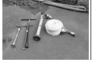
スタンドパイプ・ホース など放水装置一式
